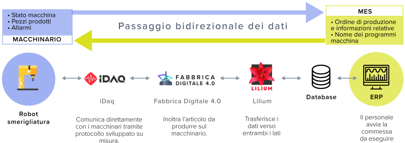
Diagramma dell'interconnessione aziendale in ottica Industria 4.0
