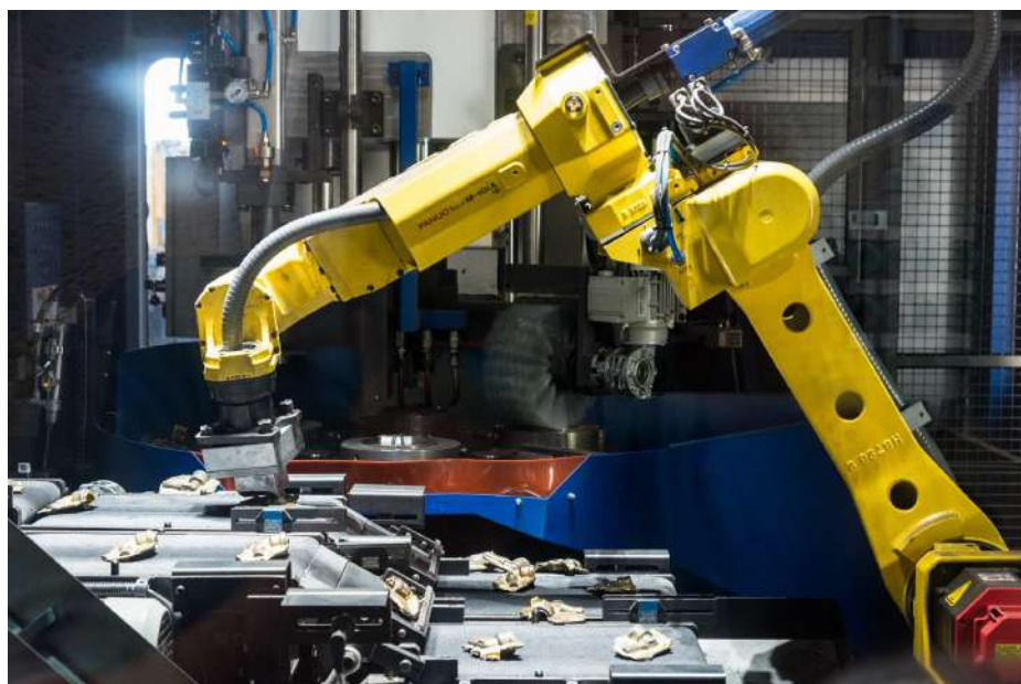
Tranciatura robotizzata delle stampati di ottone
